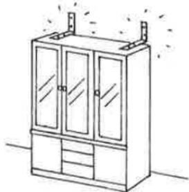
転倒防止補助金具の付いた商品は、必ず確実に取り付けてください。また、金具は建物の壁や梁にしっかり固定してください。
